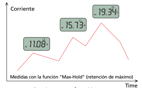
Lectura de pinza con función "MAX-HOLD" activada
