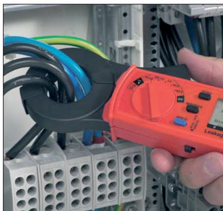
Medida de corriente diferencial con pinza de corriente de fuga
