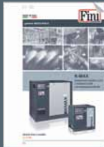
K-Max 5.5-38 Compressores de parafuso com transmissão direta, com injeção de óleo, de 5.5 a 38 kW potência, velocidade fixa e variável.
